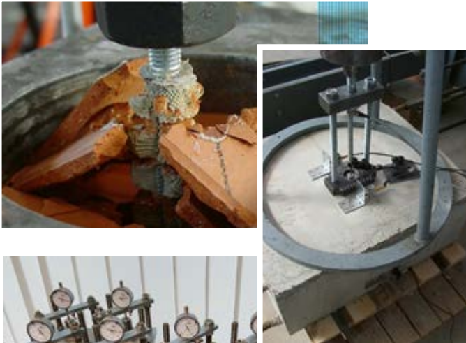
Zugversuche im Mauerwerk und Beton
